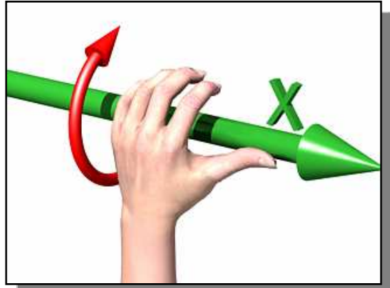
Détermination du sens de rotation positif, valable pour chaque axe.
